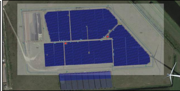
Paneelindeling, locatie omvormers en trafostations
