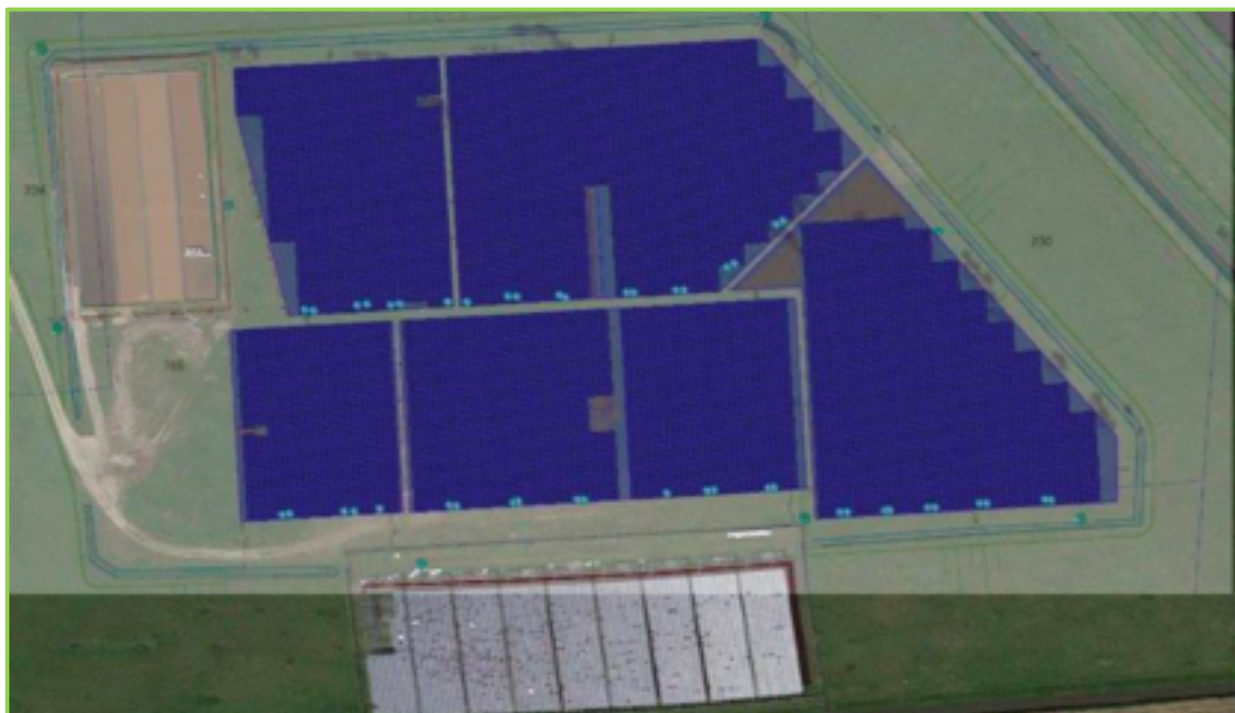
Overzicht van het EcoPark met oost-westopstelling voor LangstraatZon (afbeelding eindfase 14560 zonnepanelen)
