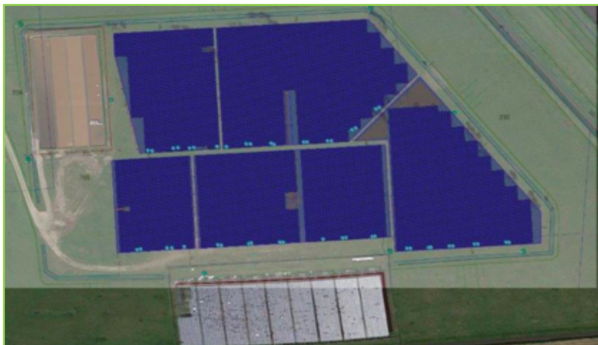
Overzicht van het EcoPark met oost-westopstelling voor LangstraatZon (afbeelding eindfase 15.000 zonnepanelen)
